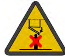
66945 – Avertissement « Ne pas se tenir dans la zone de pivotement des appareils »
