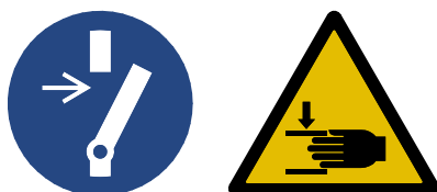
66947 – Capot d'inspection/porte de révision : « Mettre l'appareil hors tension avant toute intervention », « Avertissement : Risque d'écrasement »
